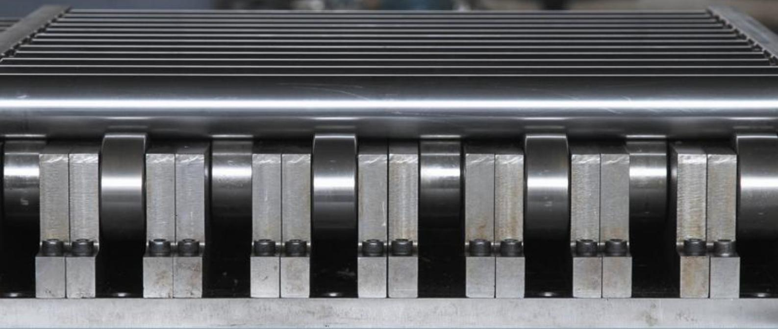
材料通过数量众多，上下两排交错布置的矫平辊进行多次反复弯曲，逐渐减少压弯挠度，直至趋于零值，最终将其矫平，使板材达到工艺要求。
